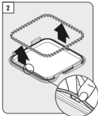
透明のフタの溝部分(図の丸印)から、パッキン(グレーのゴム)を外します。
