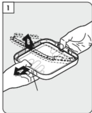
白いフレームのタブを(A)の方向に動かし、透明のフタを図のように後ろから押して外します(B)。
